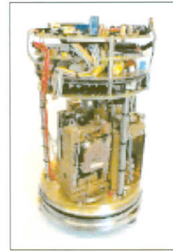
Figura 1. Antiguo cajón de la estación del CTBTO y Sensor Guralp CMG-T3E007.
